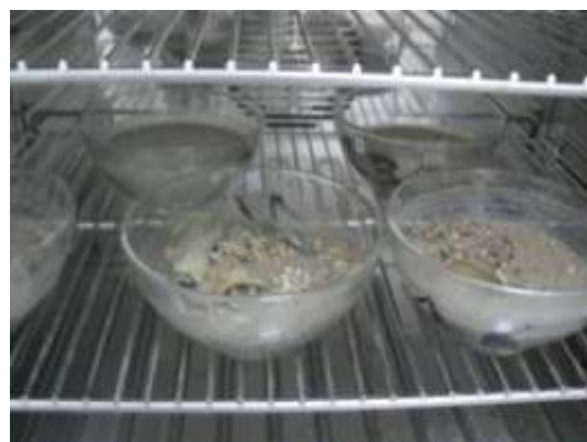
Figure 11 : Echantillons granulométriques à l'étuve (Cliché TBM).
