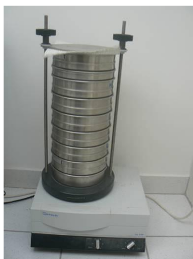
Figure 10 : Colonne de tamis (Cliché TBM).
